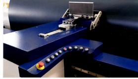
▲ 整经台: 导纱辊无需打开, 便可放入绞线, 经纱排列得到完整保持。 平整辊可以保持纱线层的平整度。
